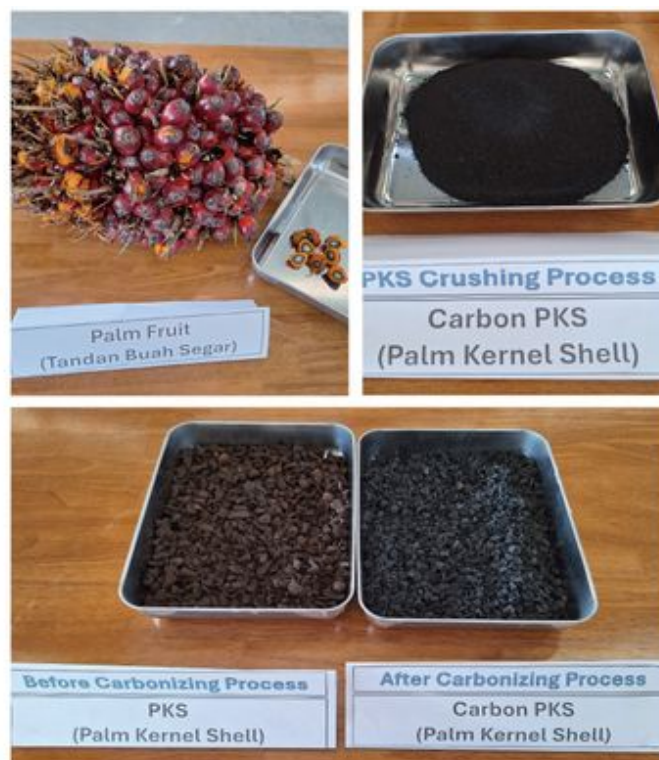
（左上）パーム成型炭の原料となるアブラヤシの実、（下左）パームヤシ殻（P K S）と（下右）炭化加工した P K S、（右上）炭化した P K S を成型加工する前に細粒化した原料＝9 日、西カリマンタン州クブ・ラヤ県（ATP バイオ・インドネシアから許可を得て NNA 撮影）
